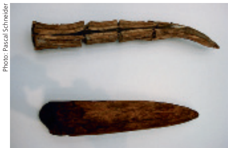
Photo 1: deux morceaux de bois de chêne issus de l'époque lacustre, l'un sorti du sol et laissé à l'air (en haut) et l'autre lyophilisé, l'eau étant remplacée par de la cire.
