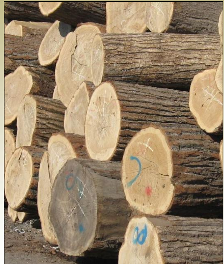
Gut erkennbar: Splint- und Kernholz.
